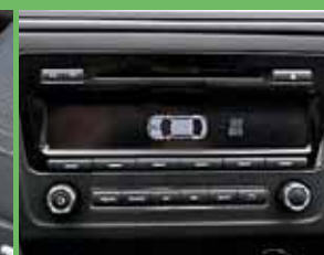
Парктроник Rio только пищит, а в чешской машине еще и рисует картинку на дисплее
